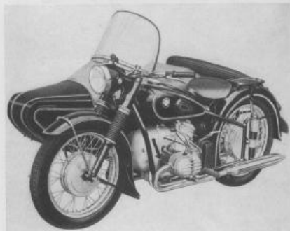
R 67/3 Baujahr 1955/56 600 ccm OHV 28 PS bei 5900 U/min
