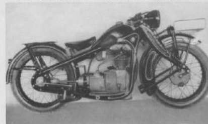
R 4 Baujahr 1932 400 ccm OHV 12 PS bei 4200 U/min
