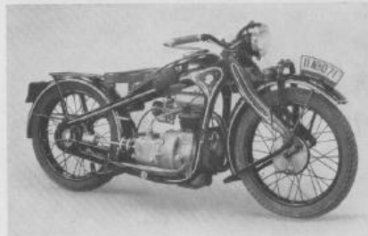
R 2 Baujahr 1936 200 ccm OHV 8 PS bei 4500 U/min
