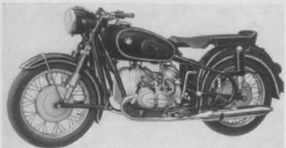
R 69 Baujahr 1955/60 600 ccm OHV 35 PS bei 6000 U/min
