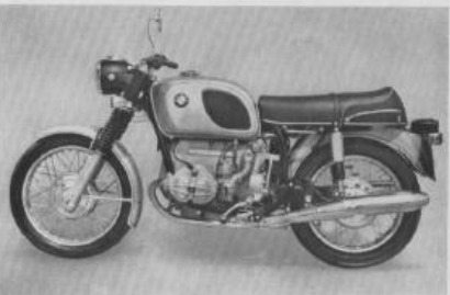
R 75/5 Baujahr ab 1969 750 ccm OHV 50 PS bei 6200 U/min mit Underdruckvergaser
