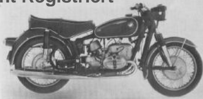
R 50 S Baujahr 1960/63 500 ccm OHV 35 PS bei 7650 U/min R 69 S Baujahr 1960/69 600 ccm OHV 42 PS bei 7000 U/min
