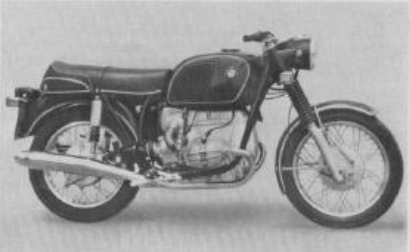
R 50/5 Baujahr ab 1969 500 ccm OHV 32 PS bei 6400 U/min R 60/5 Baujahr ab 1969 600 ccm OHV 40 PS bei 6400 U/min mit elektrischem Anlasser
