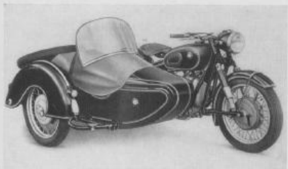
R 60 Baujahr 1956 600 ccm OHV 28 PS bei 5000 U/min
