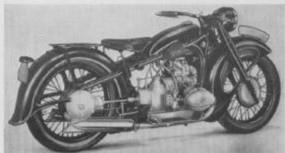
R 17 Baujahr 1935/37 750 ccm OHV 33 PS bei 4500 U/min
