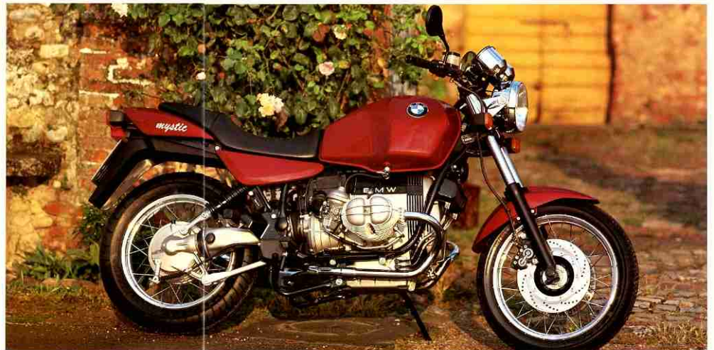
BMW R 100 R Mystic - Ausstattung u.a.: Metallic-Lack mysticrot, schwarzer Rahmen, Doppelscheibenbremse vorn, mickiger Lenker, klassisch-runde Ventildeckel, Ölkühler, Sekundär-Luft-System (SLS), Steckdos.
